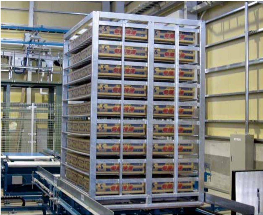
E. 内容物積んだコンテナは自動で凍結庫に移動
