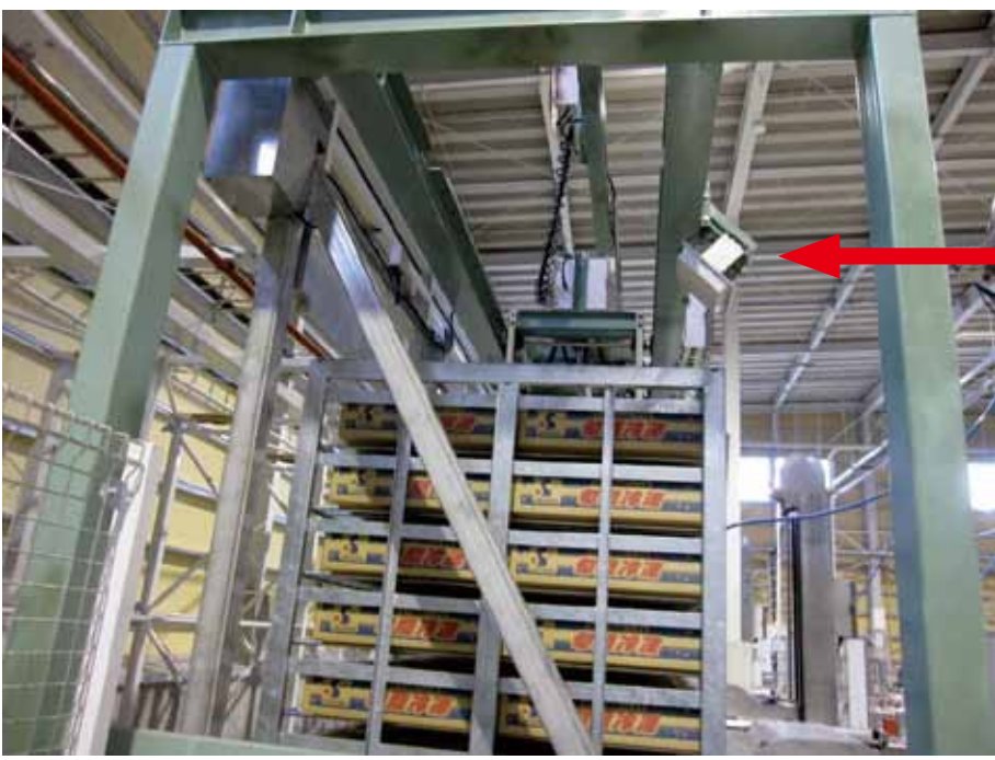
D. RFIDアンテナでコンテナ装着のRFIDに段ボールの魚の種別情報書き込み自動でコンテナに積込む
